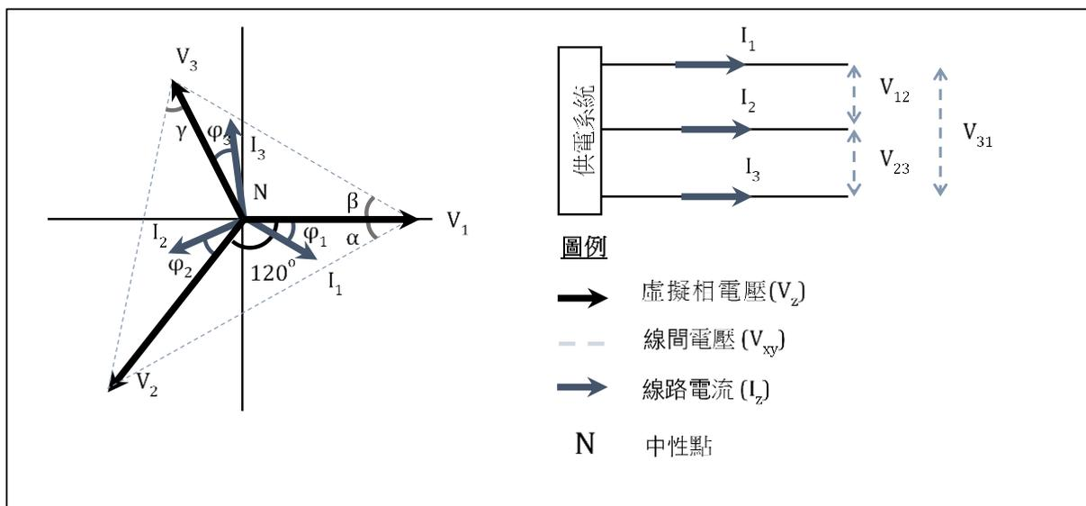
B2.3 方程式 B1 提供總功率因數計算，而有功功率（P）可以雙瓦特計方式測量。
