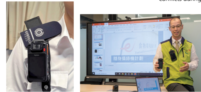
我們因應小販事務隊的運作需要，為他們提供隨身攝錄機。在採購過程中，我們仔細考慮到器材的影像穩定度、電池重量與持久度、待機模式時的預錄功能等因素。使用隨身攝錄機令衝突事件顯著減少，成效有目共睹。
