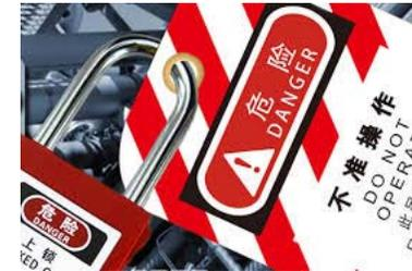
近年發生多宗涉及電力工序引致的致命工業意外。進行電力工作，安全隔離電源至為重要。為了確保已安全隔離電源，故實施一套「上鎖/掛牌」的安全工作制度。以免悲劇再次發生.....
