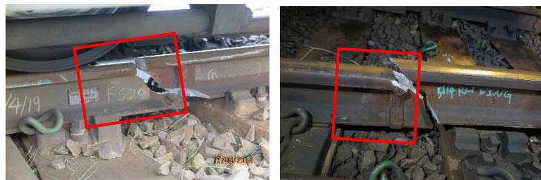
圖11：兩組斷裂的路軌
