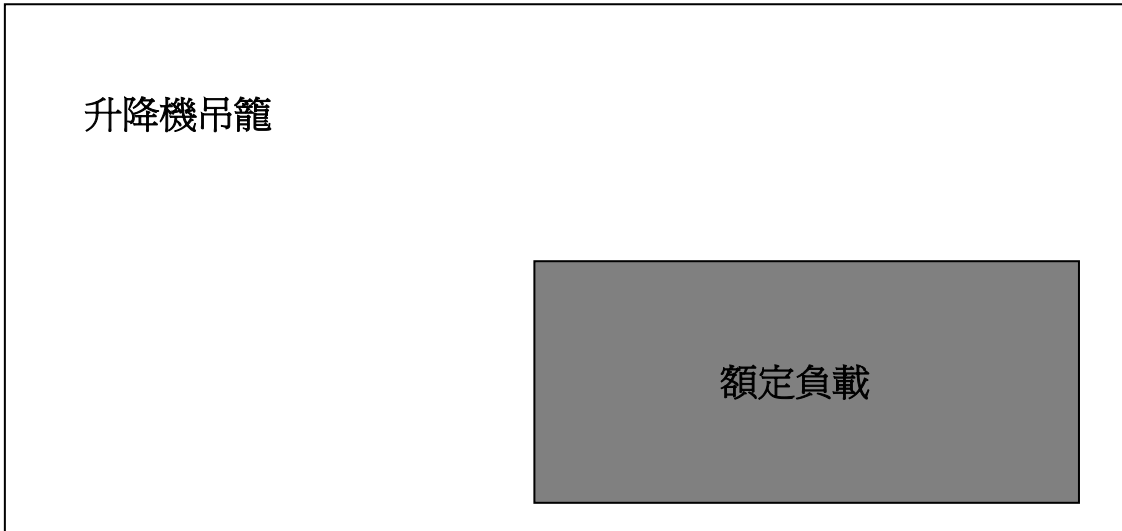
圖2：額定負載的分佈佔升降機吊籠地板面積超過75%
