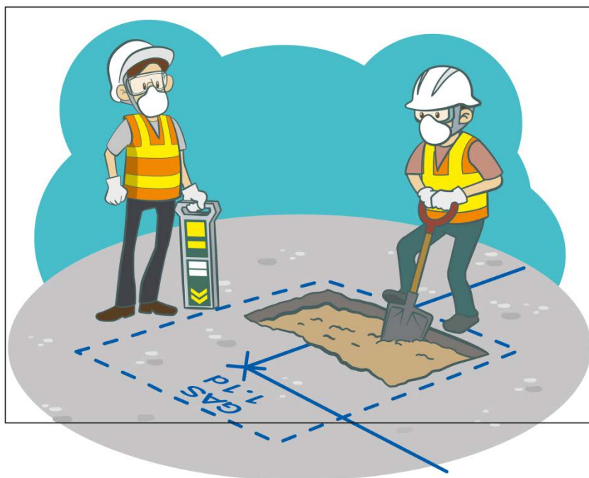
圖像 5— 使用手動工具挖掘試孔
