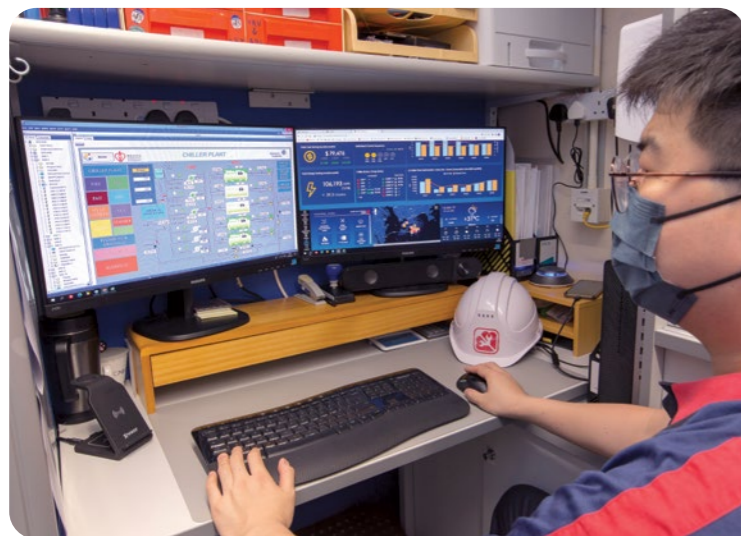
為達至提高能源效益和節能的目標，我們利用人工智能優化醫管局大樓的製冷機組，以分析及調節製冷機組的效能。
