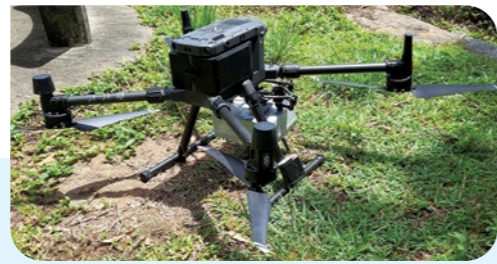
我們的團隊利用無人機搭載「政府物聯網」基站，結合定位追蹤裝置，在攀山拯救專隊成員進行訓練期間實時追蹤他們的位置。這個定位追蹤系統專為偏遠地區的行動而設，能有效協助搜救人員確定傷者或失蹤人士的位置。
